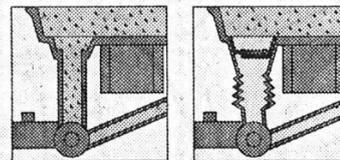
contrairement aux systèmes usuels (à gauche), la cuve est automatiquement verrouillée (à droite). Ainsi, le produit de lessive introduit dans la machine reste où il doit être exploité et n'est pas éliminé par le système d'écoulement. Résultat: 30% d'économie de produits de lessive.
