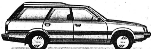
Subaru 1.8 Super-Station 4WD , traction permanente 4x4 à différentiel central, 2x5 vitesses, 98 CV DIN, servo-direction, Fr. 26 000.-.
