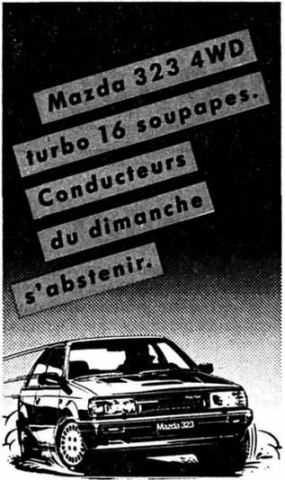
Moteur 1600 cm<sup>3</sup> à injection électronique, double arbre à cames en tête, 16 soupapes, turbo avec intercooler, 100 kW/ 136 ch. 5 vitesses. Traction intégrale permanente. Différentiel central à blocage manuel. 4 freins à disques, ventilés à l'avant. Système de régulation manuelle de la garde au sol.
