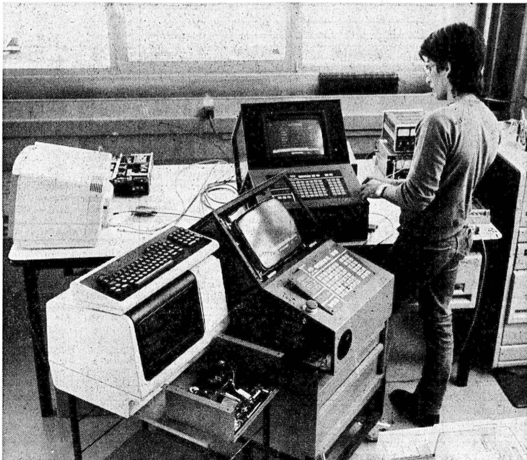
Développement sur ordinateur des ordinateurs de commandes de machines (CNC).
