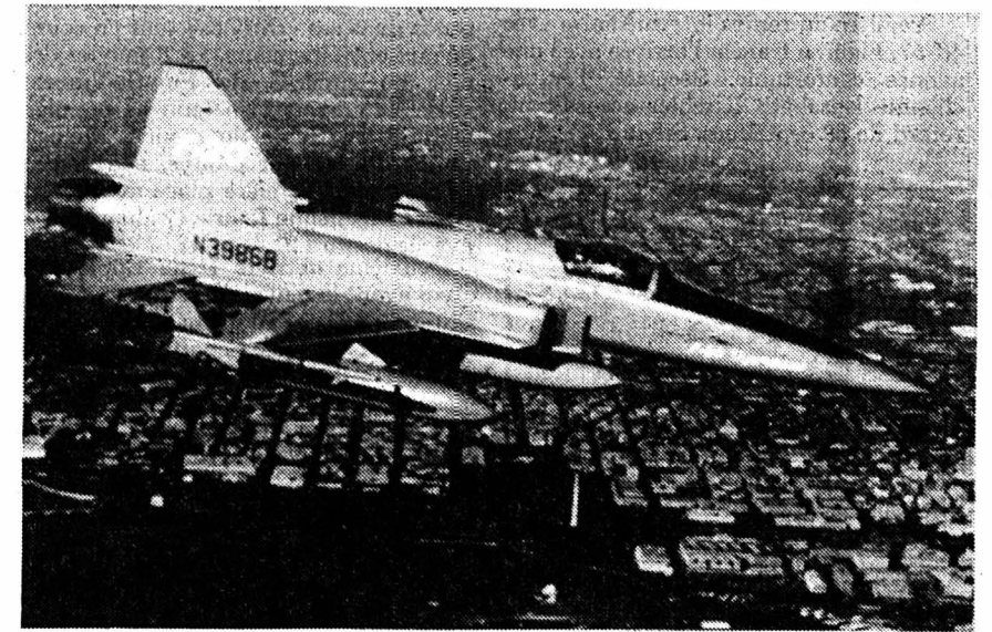
Le chasseur américain de la nouvelle génération F-20 «Tigershark» produit par la Northrop Corp. fait confiance à un réacteur unique General Electric F-404-GE-400 de 7,2 tonnes de poussée.
