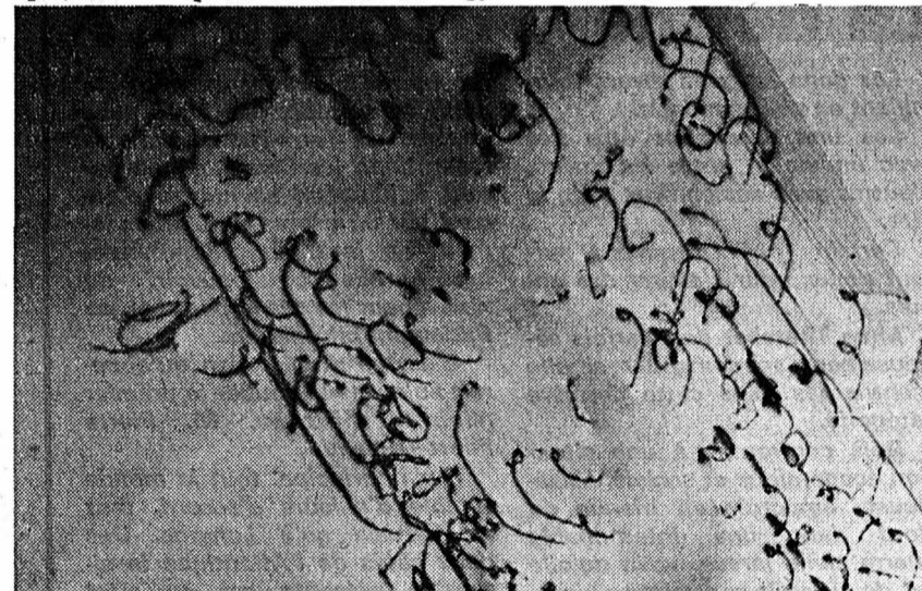
Défauts linéaires (dislocations) vues par le microscope électronique à transmission x 23000 (Photos IMS-CEH)
