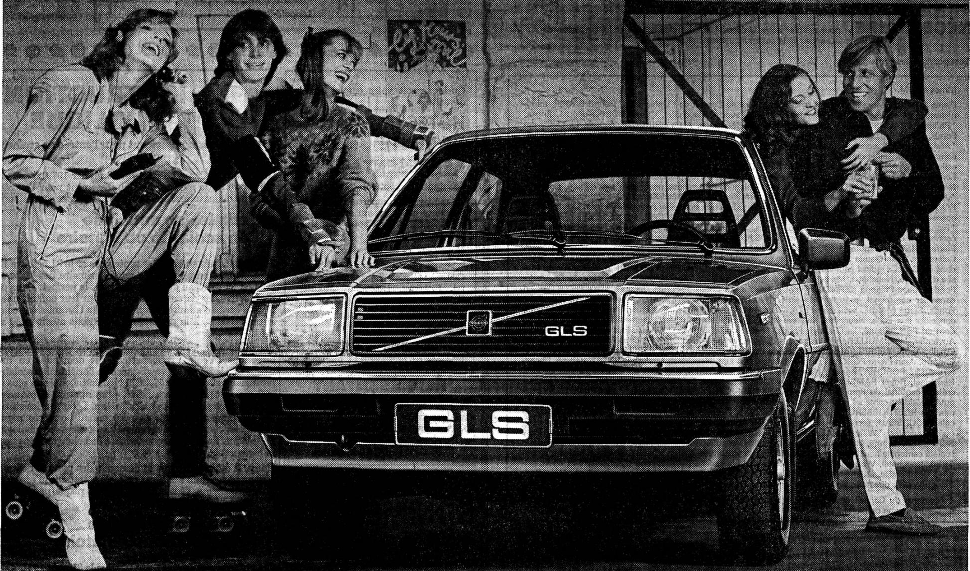
Les Volvo 340 sont renommées pour leur comportement sportivement fiable (construction transaxle avec répartition de poids 50 : 50). Elles sont disponibles maintenant avec un surcroît de puissance. Les variantes 343/345 GLS ont un moteur quatre cylindres de 1986 cm<sup>3</sup> qui développe 95 ch DIN (70 kW); le châssis et les freins ont été adaptés à cette puissance élevée. Toutes les Volvo 340 ont un hayon arrière et un coffre à bagages variable d'une contenance de 380 à 1200 litres.
