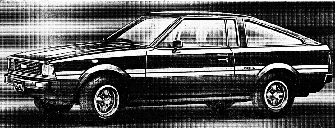
Corolla 1600 GT coupé, fr. 14 950.- 1588 cm 3 , 79,4 kW (108 ch DIN), 2 arbres à cames en tête, 2 carburateurs double-corps horizontaux, 5 vitesses
