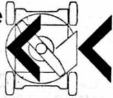
Des roues superdimensionnées se jouent des difficultés du terrain - bonne marche même dans l'herbe haute. Les roues sont agencées de telle sorte qu'elles fauchent proprement des deux côtés sans devoir revenir en arrière - plus grande simplicité pour contourner les obstacles, bordures de gazons, etc.
