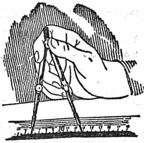
Fig. 1. Les pointes du compas „Cy-ma” permettent de porter une distance et de tracer sur du métal.
