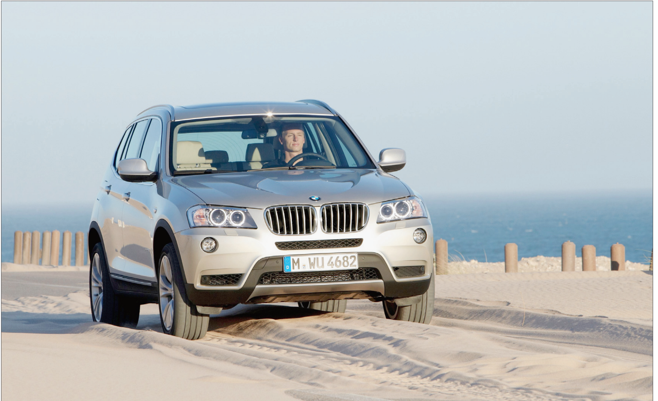
LE BMW X3 20D Il ne consomme plus que 5,6 l/100 km (contre 6,5 précédemment) grâce à la fonction start-stop, à la récupération d'énergie, aux pneus à basse résistance au roulement et à la construction allégée. (SP)
