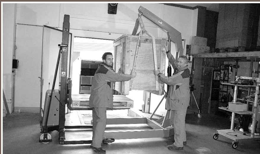
Nouvelle acquisition, la grue d'atelier de HDT (à droite) permet de soulever des machines jusqu'à deux tonnes.
