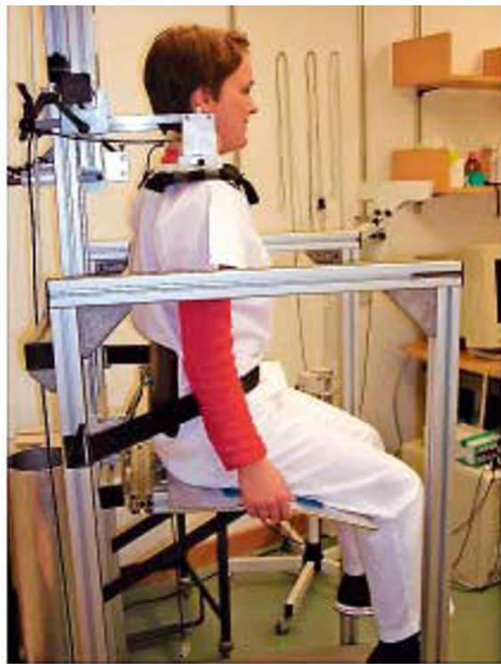
Abbildung 1: Messapparatur zur Bestimmung des EMG bei Maximalkraft (linkes Bild) und Positionierung der Elektroden (rechtes Bild). Die Sitzfläche erlaubt eine stabile Position des gegen hinten fixierten Körpers. Die Beine schweben über dem Boden, damit sie nicht zur Kraftausübung eingesetzt werden können. Die Messelektroden lagen im medialen Drittel der Linie Akromion-C7, damit die Filzpolster bei der Maximalkraftmessung genügend weit von den Elektroden entfernt waren. Diese Lokalisation wurde mit den Autoren von „SENIAM“ besprochen, entspricht jedoch nicht den aktuellen Empfehlungen (SENIAM (2012)).
