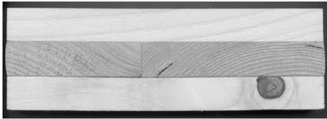
Abb. 23 Herausquellen der querliegenden Lagen im Feuchtklima bei 93% rel. Luftfeuchte Fig. 23 Swelling out of the transverse situated lamellae in the wet climate at 93% relative humidity
