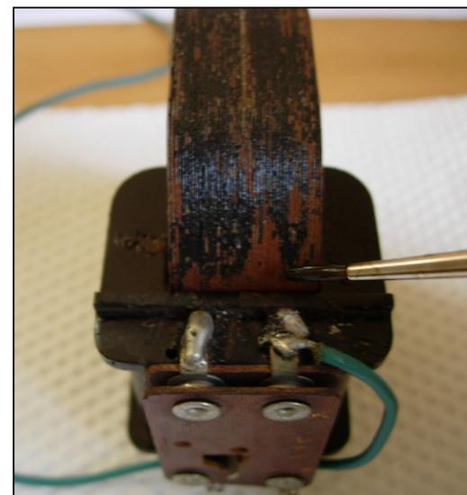
**Fig.16 Moteur LIP** Détail des corrosions sous couche peinte. © G. Rapp, 2006
