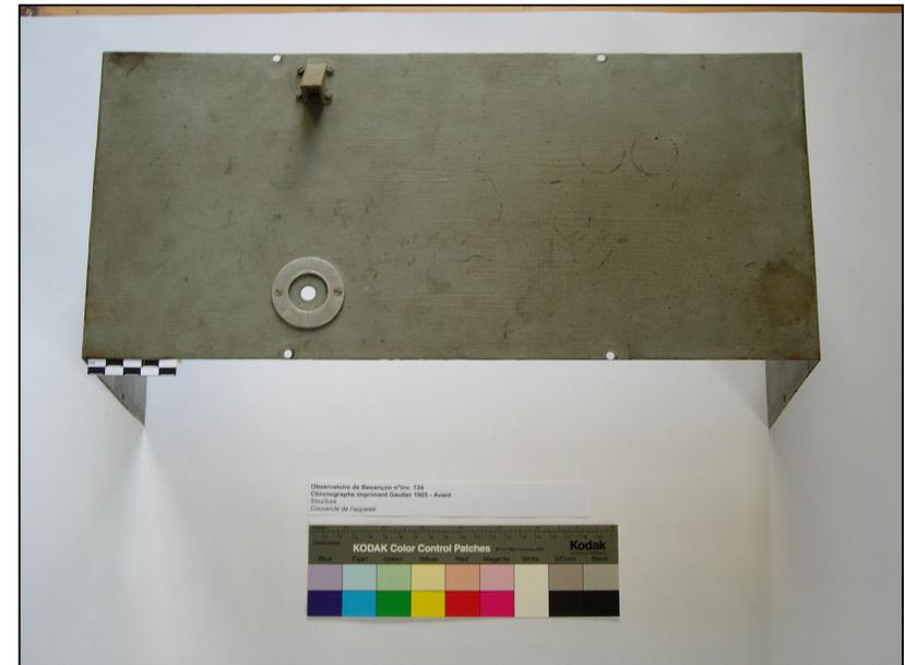
**Fig.6 Le même couvercle, vu de dessus.** On distingue quelques taches. Un prisme à 45° est monté sur la surface et joue le rôle de miroir permettant d'apercevoir un contrôle de rotation stroboscopique. © G. Rapp, 2006
