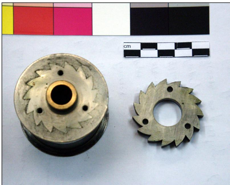
**Fig.7 Galet inférieur et rochet, avant le retrait des lubrifiants**
