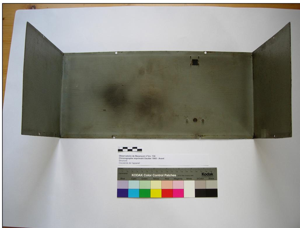
**Fig. 2** Le couvercle après traitement. La face intérieure et ses auréoles d'échauffement de l'ampoule.
