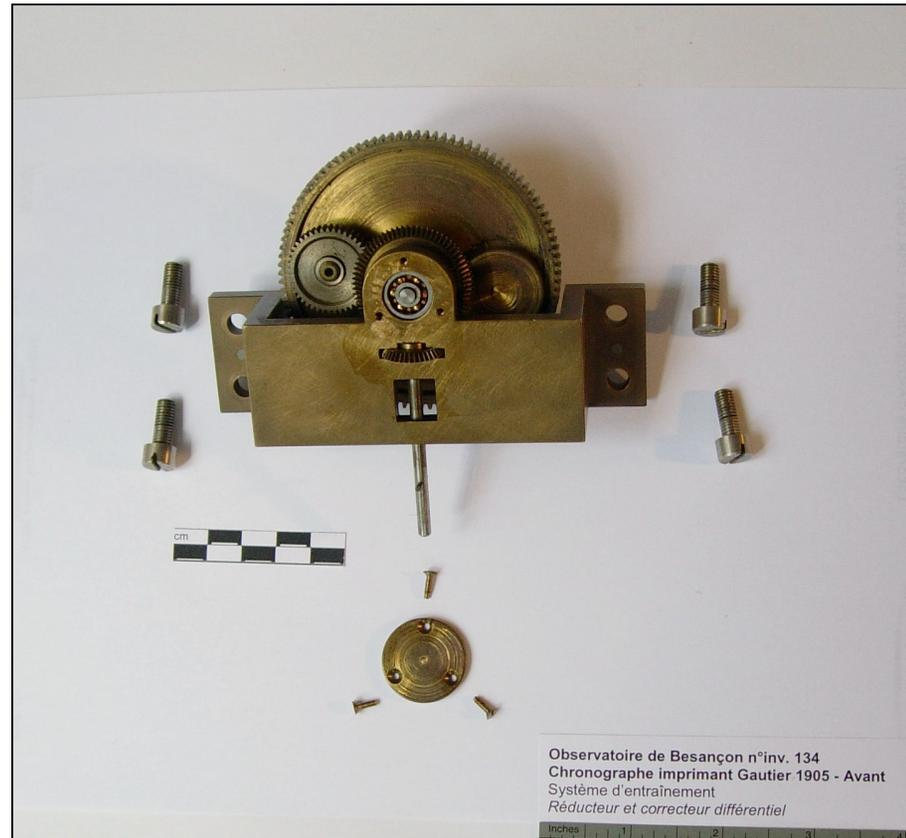
**Fig.19 Le réducteur et correcteur différentiel** assure la fonction de comptage, dans ce mouvement modifié. La version originelle mécanique nécessitait pour cela de quatre couples d'engrenages en provenance du tambour d'entraînement par poids. (Voir fig.2, p.7 de ce document) © G. Rapp, 2006
