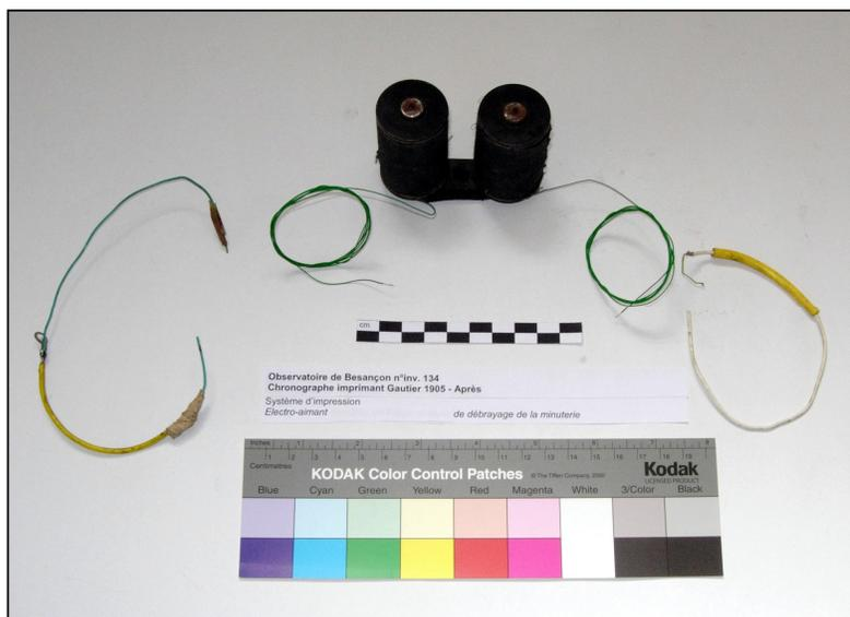
**Fig.9 L'électro-aimant de débrayage après la pose de nouveaux fils conducteurs. A côté, les anciens.**
