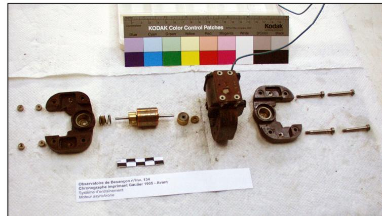
**Fig.15 Le moteur asynchrone LIP.** Demonté. © G. Rapp, 2006
