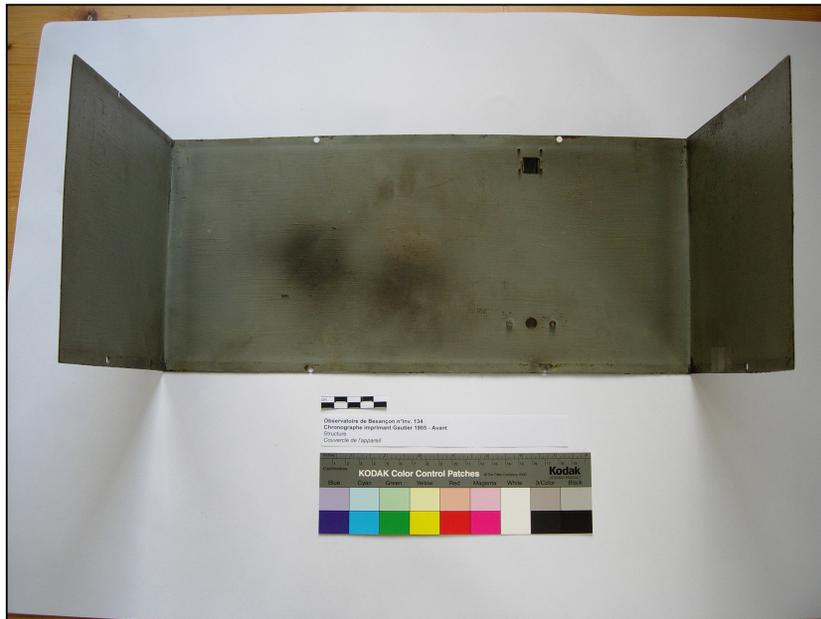
**Fig.5 Couvercle en tôle, vu de dessous.** On remarque les auréoles d'échauffement témoignant du fonctionnement de l'ampoule logée dans l'appareil. © G. Rapp, 2006
