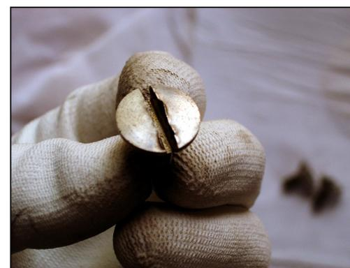
**Fig.12 Fente de vis abîmée.** Une altération fort courante.
