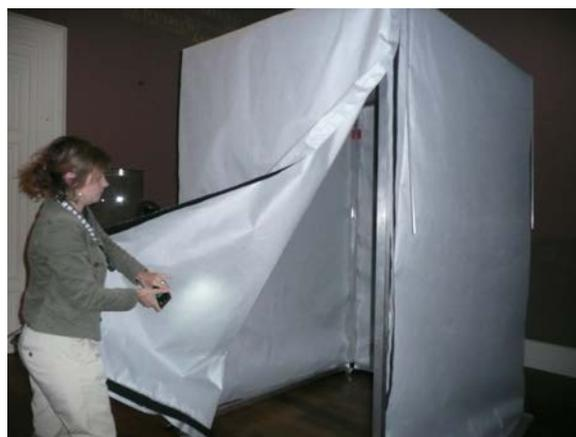
*Fig. 59* Vue de la face mobile de la cabine avec fermeture Velcro.
