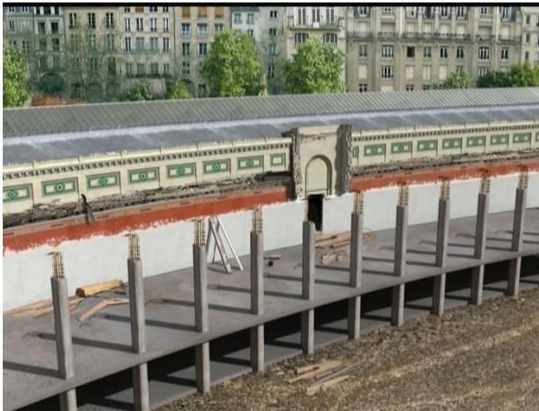
*Fig. 47* Image de synthèse illustrant la construction des piliers en béton. © Ory, 2006.
