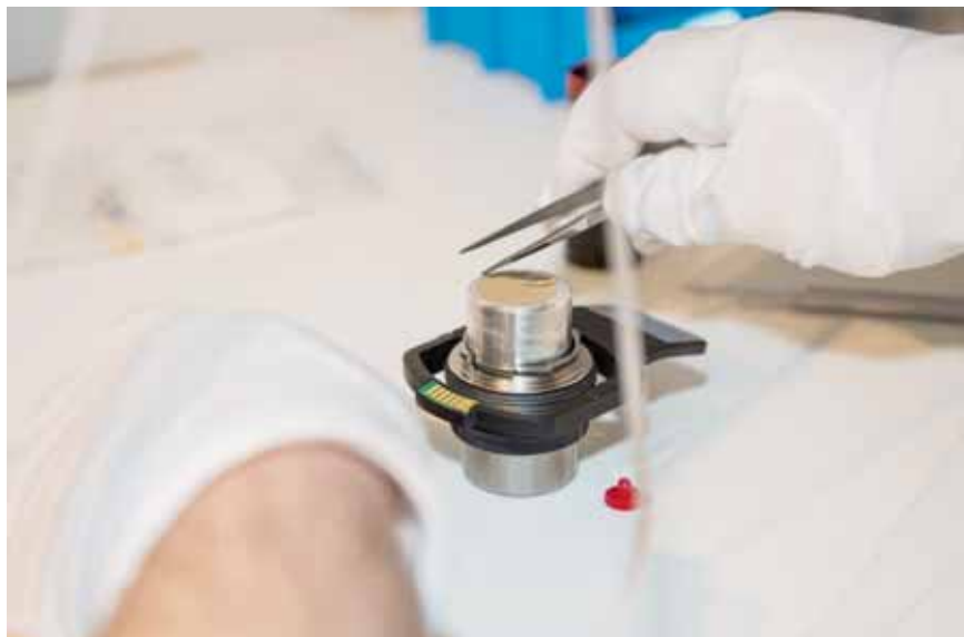
Le laboratoire de HSE Conseils à Boudry. Le filtre qui mesure la quantité d'amiante dans l'air est introduit dans un microscope avant d'être analysé dans un programme informatique. LUCAS VUITEL
