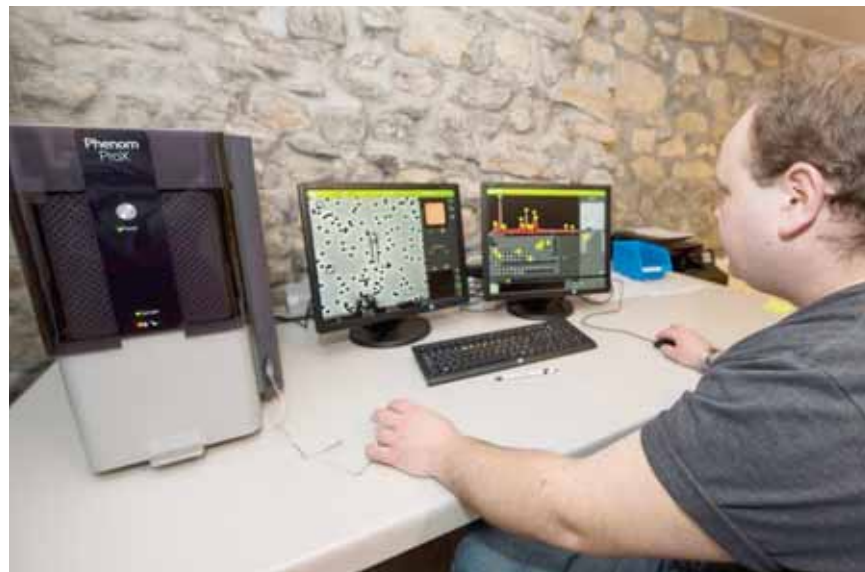
Le laboratoire de HSE Conseils à Boudry. Le filtre qui mesure la quantité d'amiante dans l'air est introduit dans un microscope avant d'être analysé dans un programme informatique. LUCAS VUITEL
