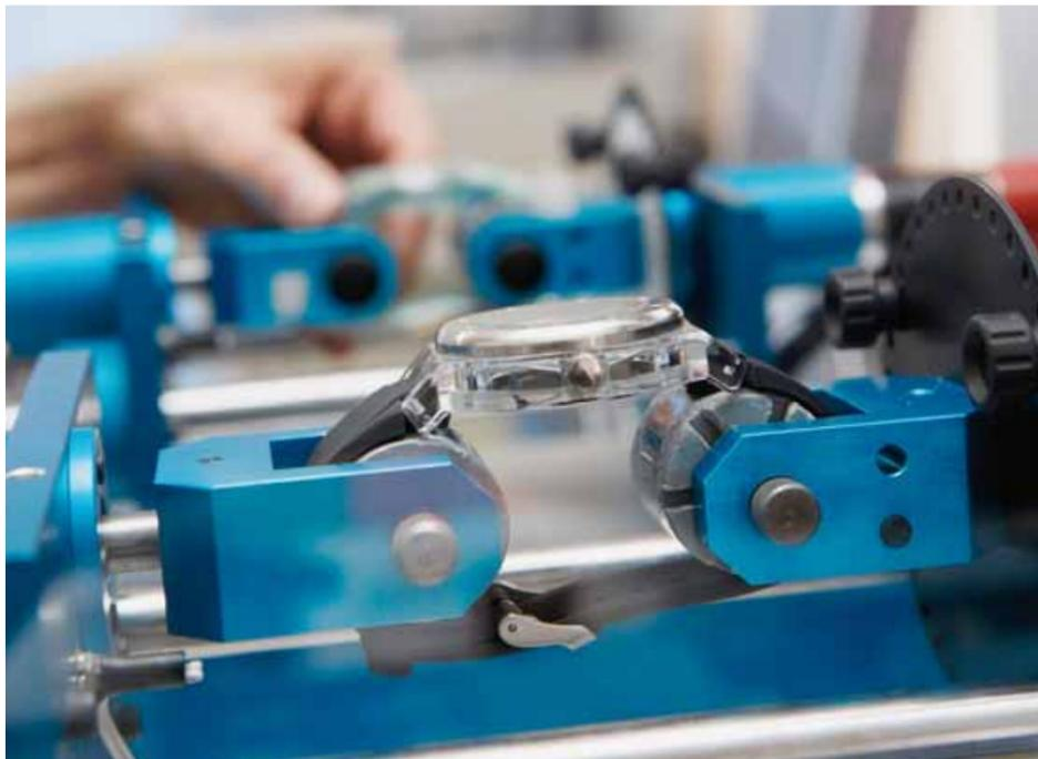
Des montres sont fixées sur le banc d'essai traction torsion dans le département cuirs et polymères du Laboratoire Dubois. Ce n'est ici qu'une des compétences de la société chaux-de-fonnière. KEYSTONE
