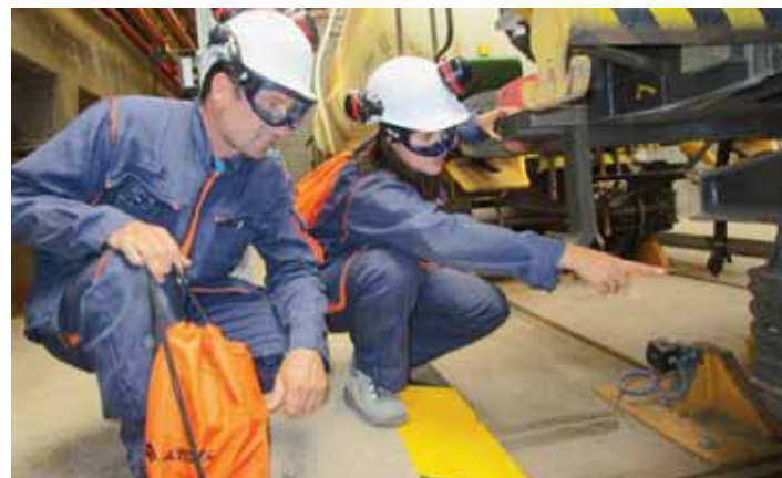
Sur le site de chargement, les opérateurs effectuent aussi des contrôles visuels pour repérer des fuites de chlore. THIERRY JACCOLET
