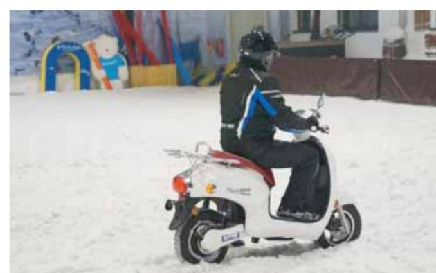
L'Urban Snow EVO, fixé sur les roues de dix pouces de diamètre de scooters électriques Kumpan, adhère suffisamment au sol pour autoriser des freinages appuyés de la roue arrière. SP-SCHAERER
