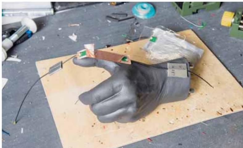
Des capteurs tactiles (à droite) seront intégrés en sandwich dans une peau en silicone (à gauche, ici transparente) qui «habillera» la prothèse. PHOTOS LUCAS VUITEL
