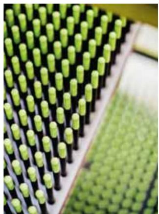
**Encapsulation** Le crayon est quasi achevé. On procède au bain, qui dépose à son extrémité le rappel de sa nuance de couleur. SP
