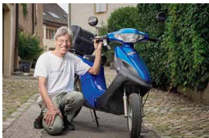
Le Mobilec peut atteindre 35 km/h, et possède une autonomie de 40 km avec des batteries au lithium. DAVID MARCHON
