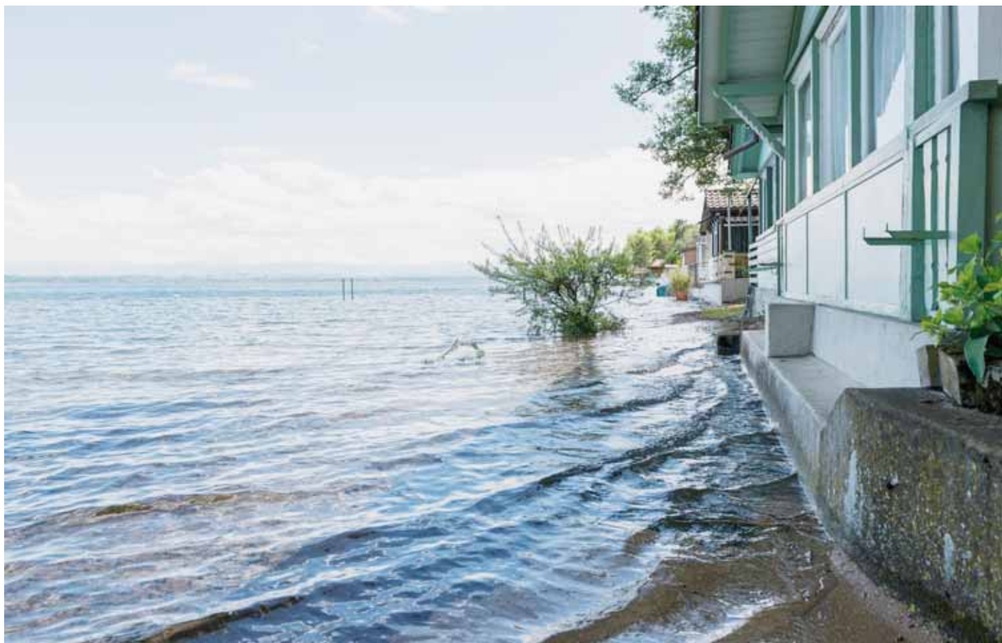
Pour ne pas subir les crues du lac, les ingénieurs civils doivent tenir en général compte de la cote de 430m50 dans leurs projets. LUCAS VUITEL
