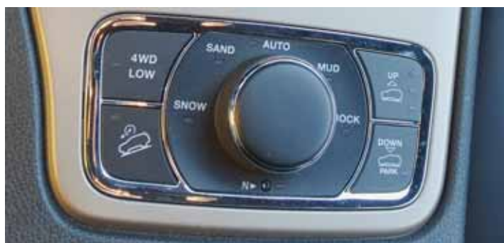
Dans les SUV les plus sophistiqués, toutes les fonctions 4x4 sont électroniques et concentrées sur une mini-console. SP
