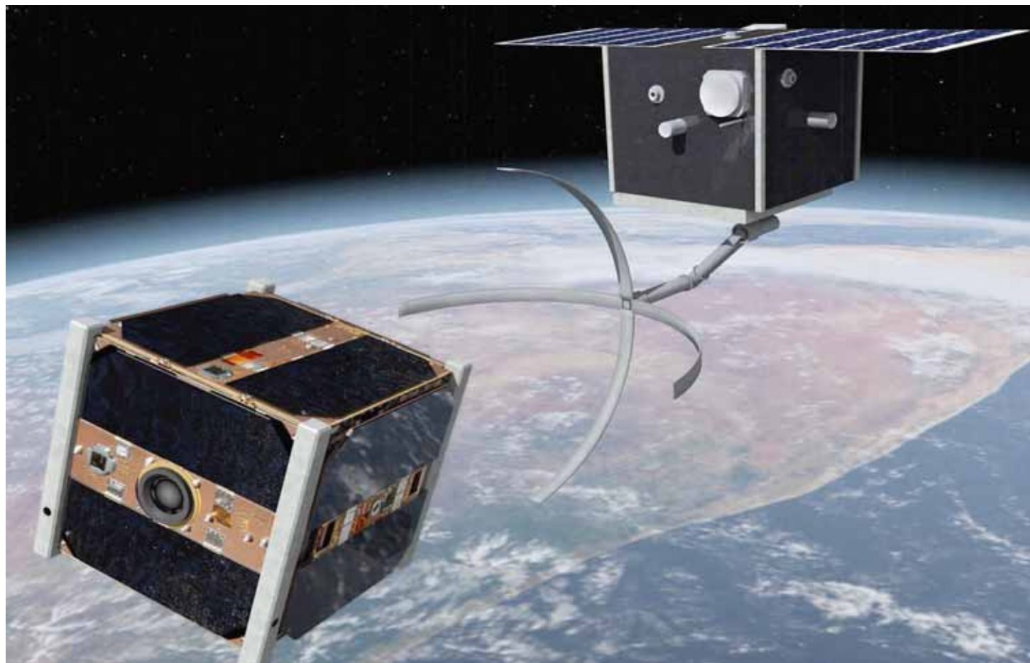
Au premier plan, SwissCube fait 10cm de côté. Le nettoyeur Clean Space One doit aller l'attraper et le désintégrer dans l'atmosphère. SP-EPFL
