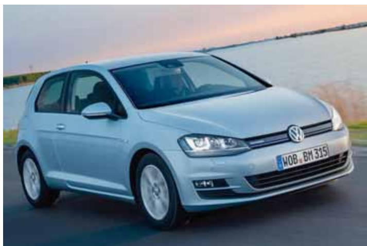
Si le 1.6 TDI CR FAP habituel établit sa consommation mixte à 3,8 l /100, sa version BlueMotion, avec boîte 6 vitesses, abaisse sa consommation normalisée de 0,6 l /100, avec 85 g /km de CO 2 contre 99 g /km. DR
