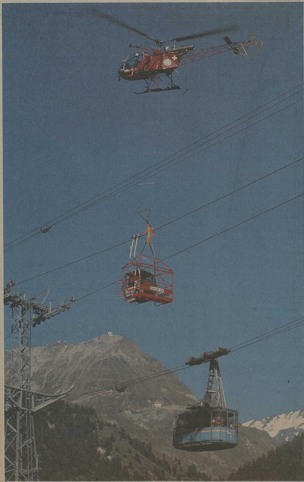
Notre photo: un système simple, efficace et rationnel pour secourir des personnes prisonnières d'une télécabine.
