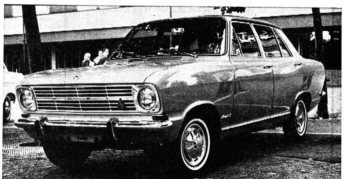
Modèle Deluxe: moteur S avec 60 cv SAE, freins à disque à l'avant et à tambour derrière, roues de 13 pouces, boîte normale de quatre vitesses avec levier au plancher.
