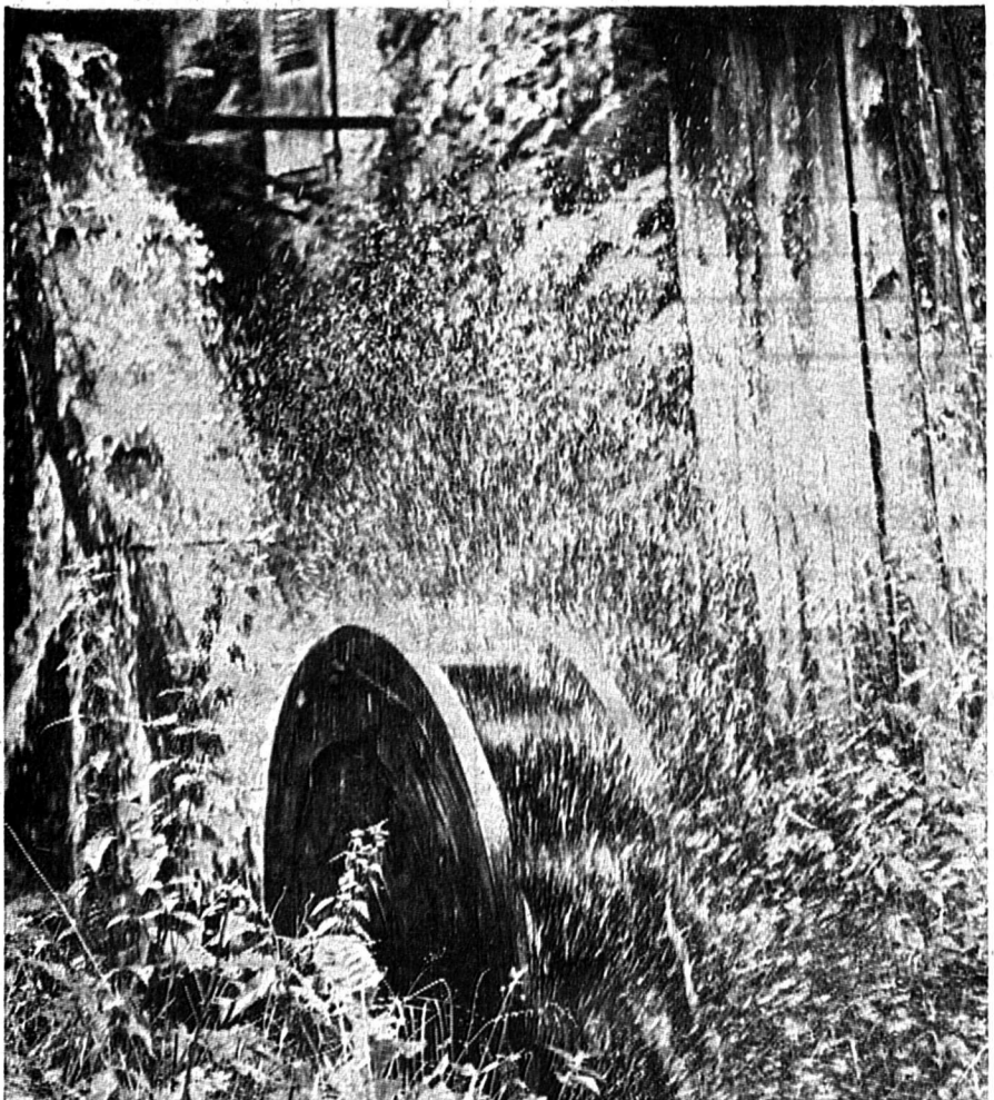
La roue à aubes, encore actuellement, actionne une installation mécanique au bord du Durnand, ancienne forge appartenant à M. Alexis Jacquéroz. Transformée en atelier de menuiserie, ses marteaux, encore en état de fonctionner, disparaissent, dans un débarras, sous des toiles d'araignées et une couche de poussière. Mais la scie circulaire, la scie à ruban, la raboteuse tournent, tournent, tournent, mues par la force hydraulique.
