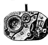
5 1/4 lig., c. 510 cyl., à ponts Recta et ovalisés
