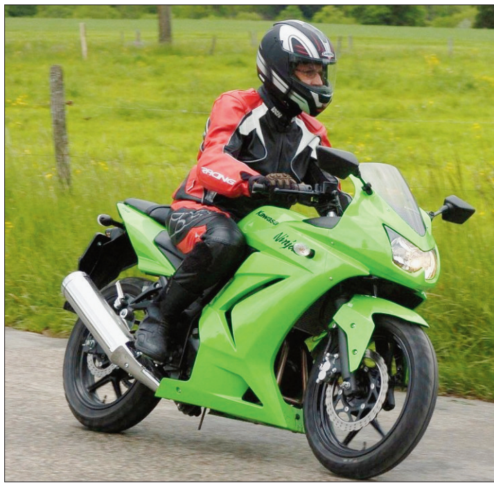
KAWASAKI NINJA 250R Un bon empattement, une selle basse et un guidon bien dimensionné permettent que le motard trouve ses aises sur ce deux-roues.
