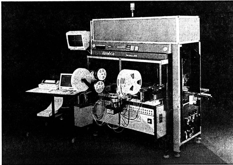
«Moduline II», la machine la plus rapide sur le marché avec une production de 6000 composants placés à l'heure.
