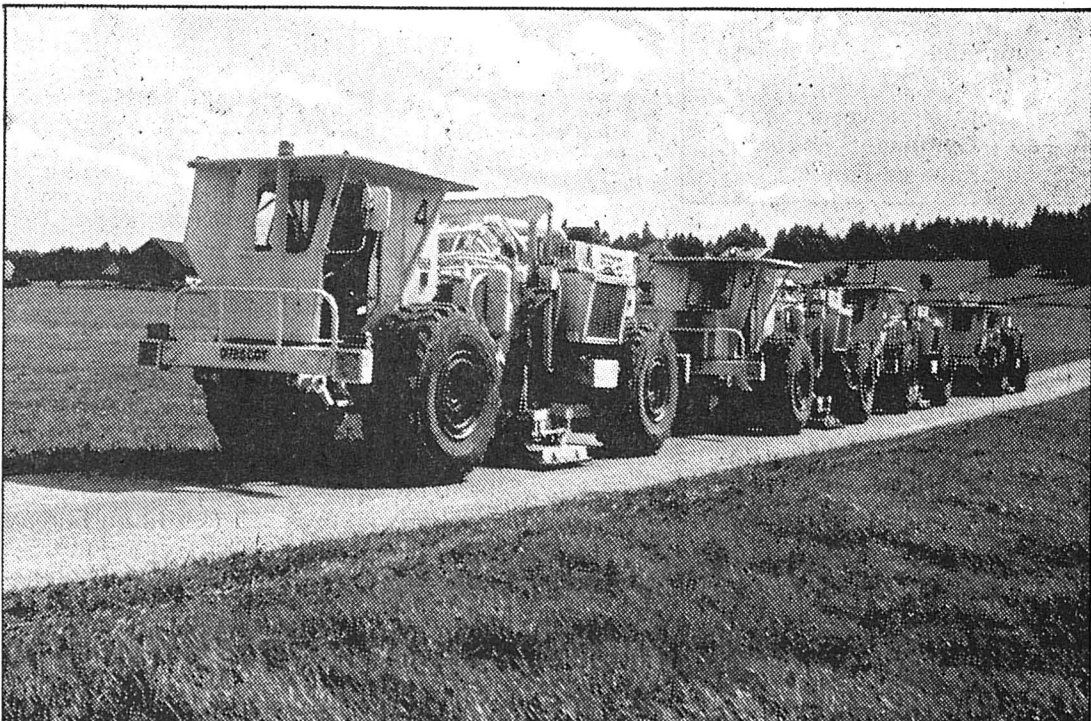
Munies de plaques vibrantes, ces machines de 13,5 tonnes chacune sondent le sous-sol dans le but de trouver d'éventuels dépôts d'hydrocarbures. (Photo Impar-Favre)
