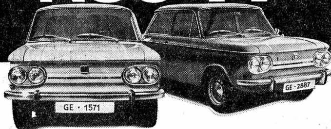
Le petit «bolide» NSU avec toutes les caractéristiques d'une vraie sportive: deux carburateurs, compteur de tours, radiateur d'huile, pneus à carcasse radiale, volant sport, phares doubles. Et un châssis avec trapèzes et ressorts hélicoïdaux avant et bras oscillants placés en biais à l'arrière. Avec jantes ajourées pour refroidissement des freins. Autant de perfectionnements qui font de la TT une cinq places confortable, luxueusement équipée.
