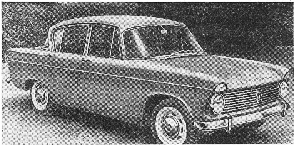
La Hillman Super Minx se distingue par un nouveau moteur de 1,6 l développant 66 CV, qui lui assure des accélérations rapides et une vitesse de pointe supérieure à 135 km/h. Sa suspension améliorée lui confère une remarquable tenue de route.
