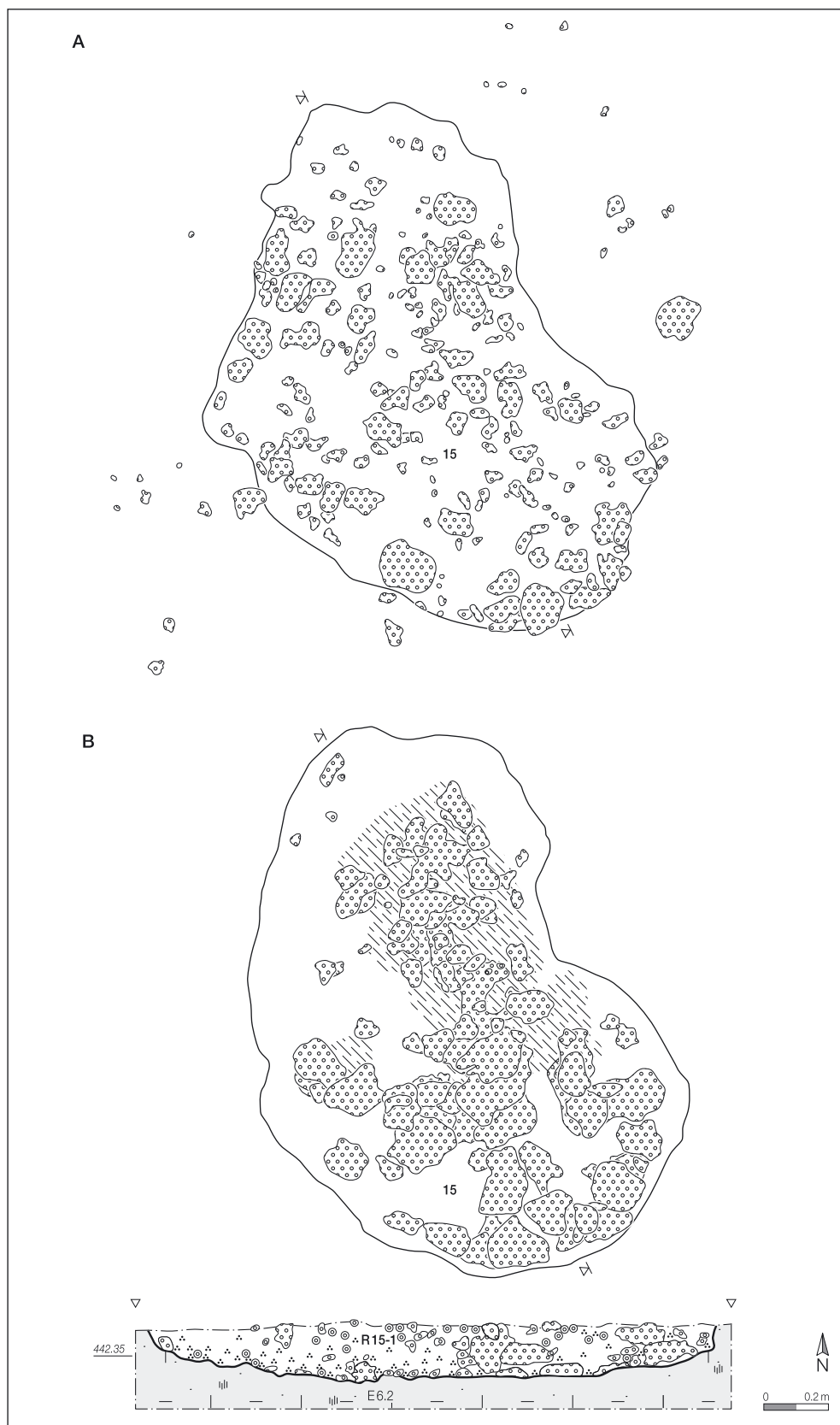
Fig. 142 Zone d'activité 4, plan et coupe du bas foyer 15. A : plan d'apparition de la structure; B : plan de la base de la structure avec les scories collées au fond et les traces de rubéfaction.
